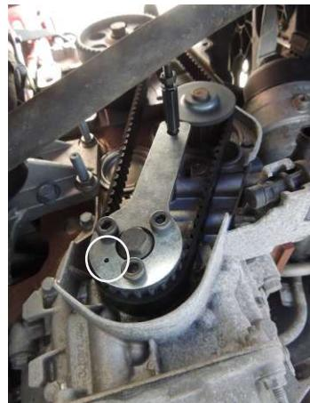
Monter l'outil 2000034400 à l'emplacement de la pompe à vide pour bloquer l'arbre à cames. ATTENTION à l'orientation
