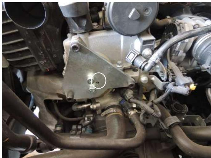
Desserrer la vis de fixation de la roue d'arbre à cames. (clé de 18 & clé anti couple)
