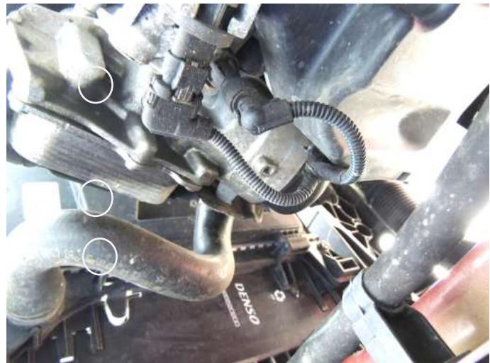
Remonter la fonderie support moteur ( 5 vis) serrer au couple
