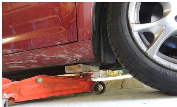
Démonter le pare-poussière dans le passage de roue AVD (4 vis)
