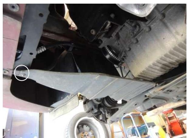
Remonter la roue avant droite serrer au couple, reposer le véhicule
