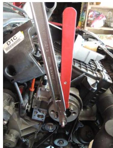
Démonter l'écrou du tendeur mobile et déposer le tendeur et la courroie de distribution
