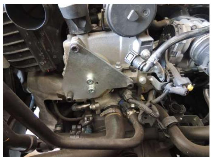
Faire deux tours au vilebrequin dans le sens normal de rotation, puis repositionner les outils utilisés pour vérifier le calage du moteur.
