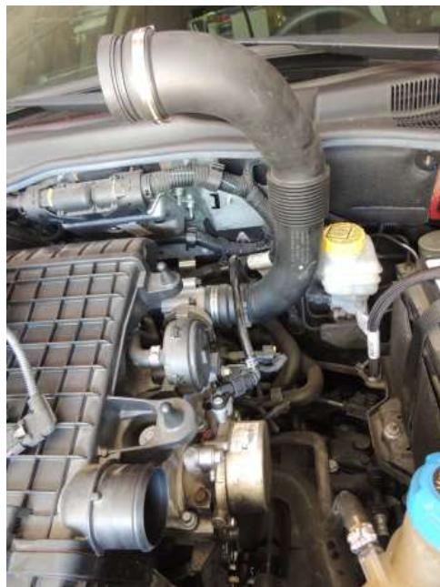
Débrancher le tuyau de dépression et démonter la pompe à vide (3 vis) ATTENTION de l'huile va s'écouler
